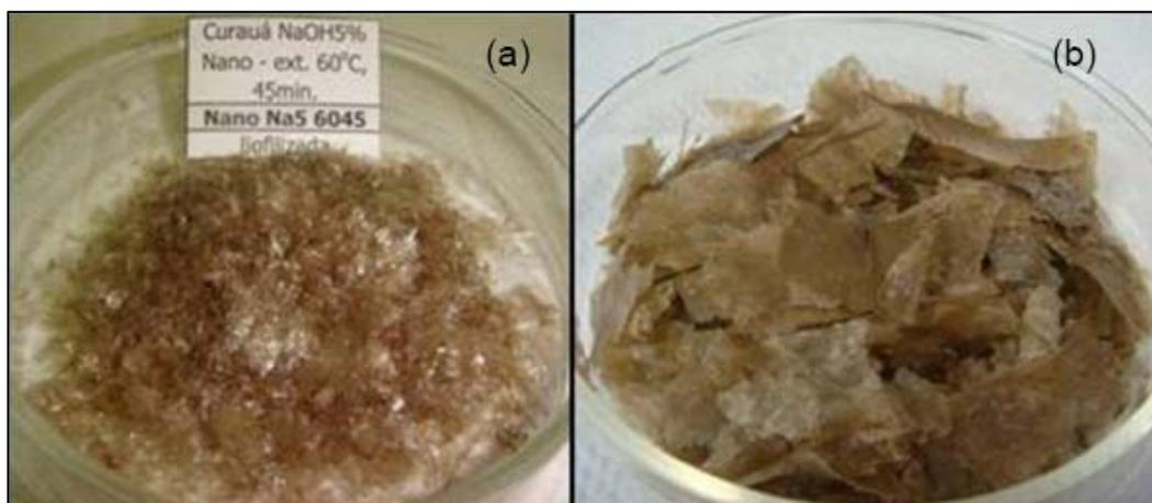
**Figura 2:** Nanofibras de curauá secas: (a) por liofilização; (b) em estufa com circulação de ar.
