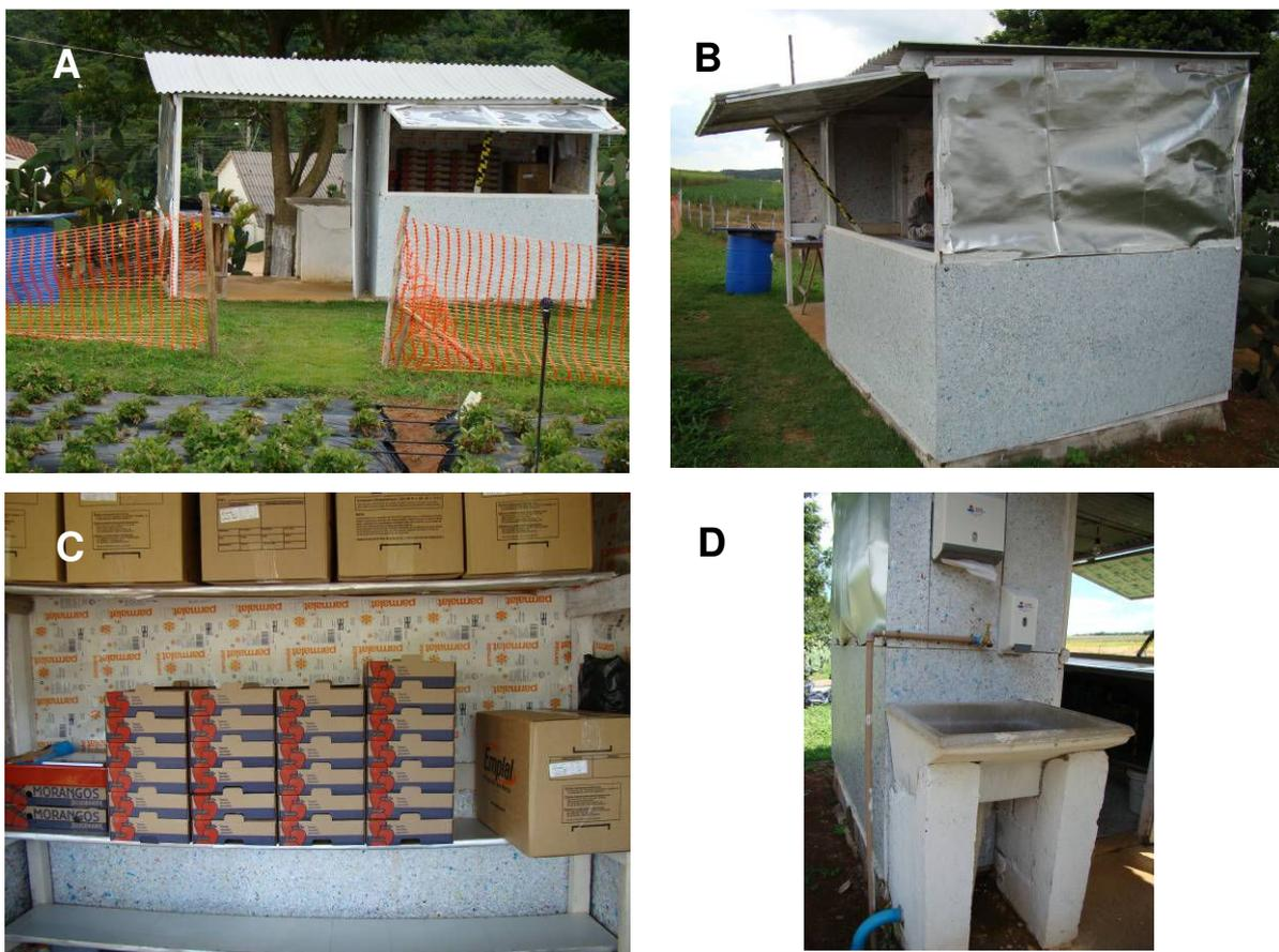
**Figura 1.** **A)** Vista frontal da casa de embalagem da PIMo, mostrando as áreas interna e externa; **B)** Vista lateral, mostrando a janela basculante para entrada de luminosidade, a placa plana ECOTOP nas paredes inferiores e as folhas de Tetra Pak® nas paredes superiores; **C)** Prateleiras no interior da Casa de embalagem, revestidas com folhas de Tetra Pak® com o laminado para fora, visando permitir a limpeza das superfícies; **D)** Instalações para lavagem de mãos.
