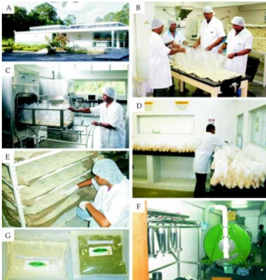
Figura 8. Unidade de Biocontrole do Cepec, na Ceplac, em Ilhéus, BA, utilizada para a produção do Tricovab® (A); preparo do substrato (B); autoclavagem do substrato (C); inoculação (D); secagem do produto (substrato + fungo) (E); equipamento separador de esporos do fungo da superfície do arroz (“MycHarvester”), doado pela “Masterfoods” (F); substrato + esporos (Tricovab®) (esquerda) e esporos de Trichoderma stromaticum (direita) (G).
