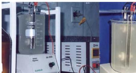
**Figura 1.** Equipamento: fonte de corrente contínua e aparato com eletrodos e agitador magnético, para rotina de aplicação do tratamento eletrolítico
