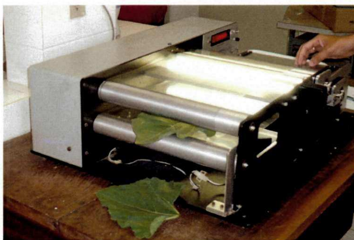
Figura 14. Determinação da área foliar de plantas de algodão através do integrador de área foliar, LICOR modelo LAI-3100.
