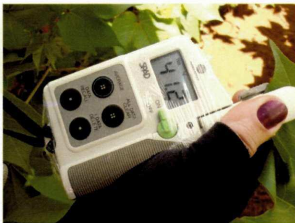
Figura 17. Medidor de clorofila SPAD-502 em utilização na cultura do algodoeiro, em Apodí, RN
