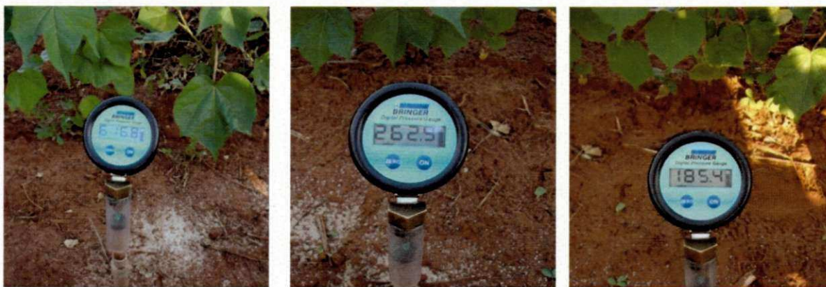
Figura 12. Medição com tensiômetros instalado em diversas profundidades no campo experimental de Apodi, RN.
