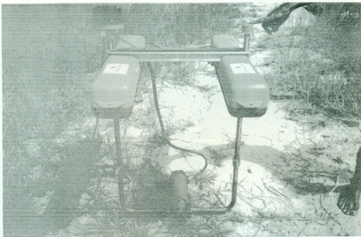
Figura 3: Aerador elétrico tipo propulsor de ar utilizado nos tanques de juvenis.
