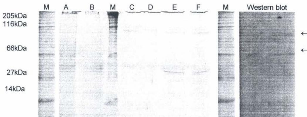
FIGURA 2. Eletroforese em SDS-PAGE e Western Blot, da  $\beta$ -galactosidase extraída de casca de jaboticaba no estágio maduro (M=marcador, A=extrato bruto, B= $(NH_4)_2SO_4$ , C e D=Sephacryl S-200, E e F=Phenyl Sepharose CL-6B. Lavras, MG. UFLA, 2002.
