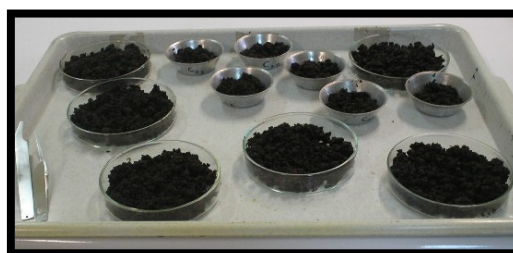
Figura 11. Amostras do substrato teste contaminado para posterior determinação de umidade e pH. (Foto: Camila Mestrinho)
