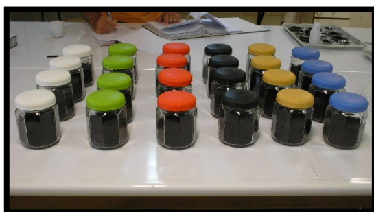
Figura 10. Frascos de vidro contendo substrato teste contaminado. (Foto: Camila Mestrinho)
