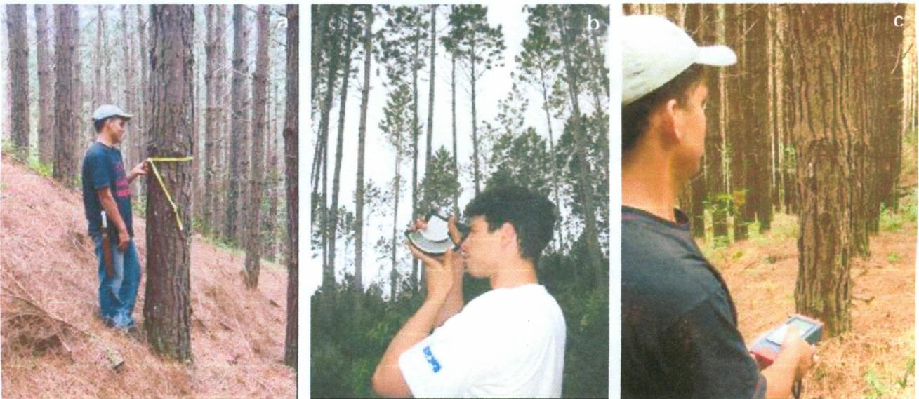
Figura 03 – Inventário Floresta (a) medição da circunferência à altura do peito (CAP) com a utilização de fita métrica, (b) medição de altura das árvores com hipsômetro de Blume-Leiss e (c) determinação dos limites da parcela com a utilização de um distanciômetro
