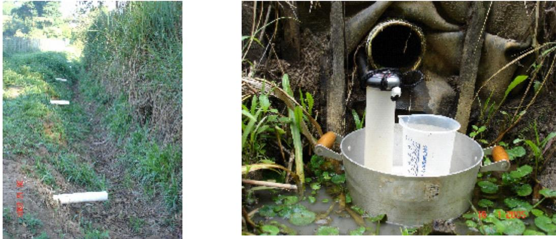
Figura 13 – Medição das descargas dos drenos da área experimental
