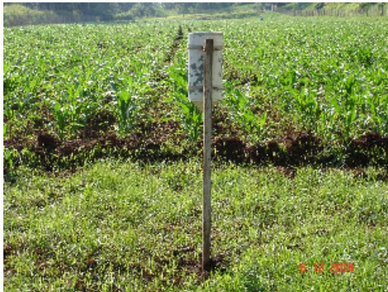
Figura 14 – Pluviômetro instalado ao lado da área experimental
