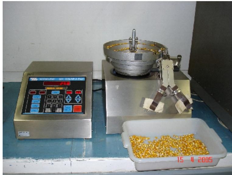
Figura 9 – Máquina contadora de grãos
