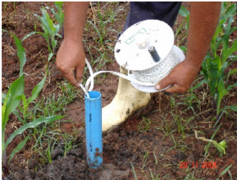
Figura 12 – Medição da profundidade do lençol freático nos poços de observação
