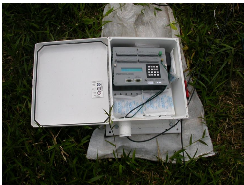
Fig. 1. Datalogger Campbell CR 23 X utilizado para armazenar as estimativas da umidade volumétrica do solo por sondas TDR.
