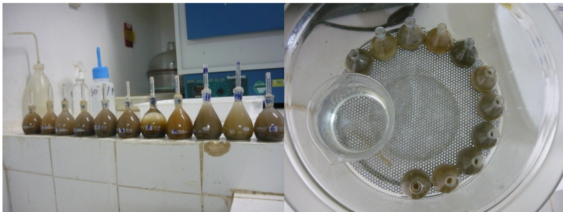
Figura 4. Picnômetros de 50 ml utilizados para determinação da densidade de partículas do solo.
