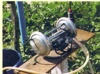
Sistema de injeção de fertilizantes para fertirrigação
