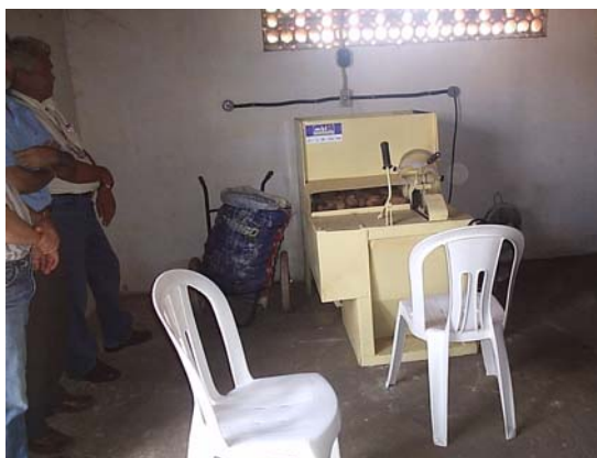
Figura 6- Máquina “fatiadora” de babaçu da empresa MBL
