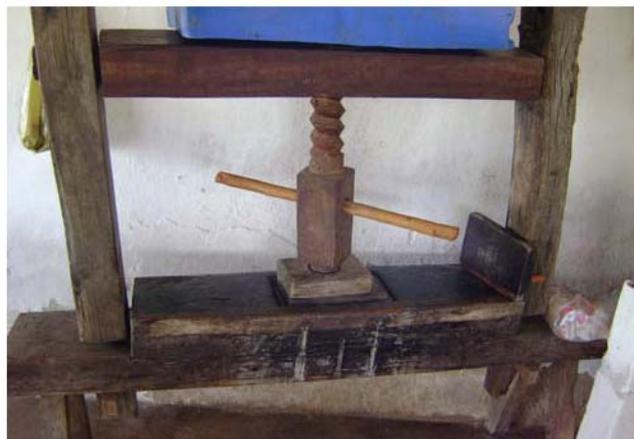
**Foto 1 – Prensa de mesa para ate 2 queijos**      **Foto 2 – Prensa em parafuso para ate 2 queijos**
