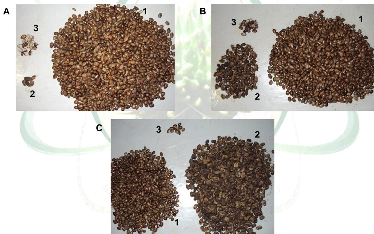
**Figura 2.** - Material separado manualmente após o processo de descascamento de *R. communis* cultivar BRS Energia com distanciamento de 0,5 cm (A), 1,0 cm (B) e 1,5 cm (C), cujas numerações representam: 1 - Sementes intactas; 2 - Sementes com casca; 3 - Sementes danificadas.
