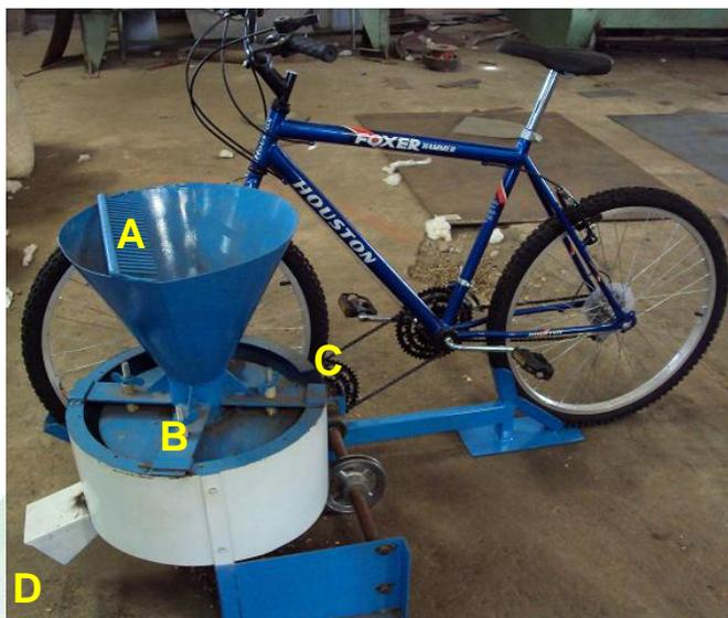
**Figura 1.** Componentes do descascador de frutos de *R. communis*: Alimentador (A); sistema de descascamento – discos (B); sistema de acionamento - pedal de bicicleta (C); e descarga do material descascado (D).
