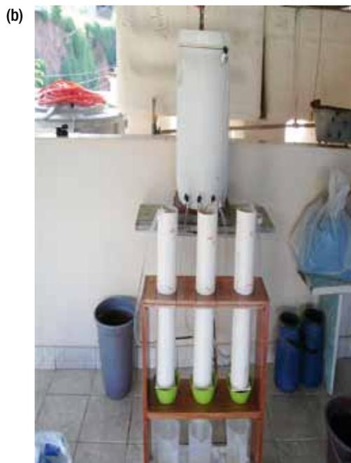
Fig. 1. Equipamento utilizado para medir a condutividade hidráulica saturada. Foi mantido um fluxo estacionário de água ( $Q$ ) sobre a coluna. (a) Esquema de montagem, (b) Foto.
