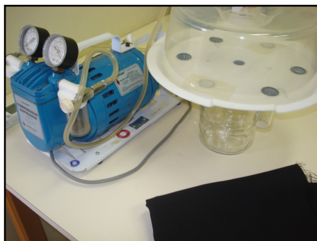
Figura 1. Olfatômetro para teste de livre escolha de Spodoptera frugiperda (J. E. Smith) em hospedeiros, Sete Lagoas-MG.
