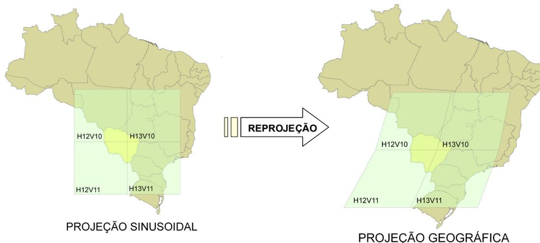
**Figura 2.** Ilustração do mosaico contendo os quatro recortes (*tiles*) cobrindo o Estado do Mato Grosso do Sul antes e após o processo de reprojeção cartográfica das imagens.
