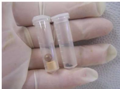
Figura 1. Microtúbulos contendo *beads* de cerâmica (A) e de tungstênio (B).
