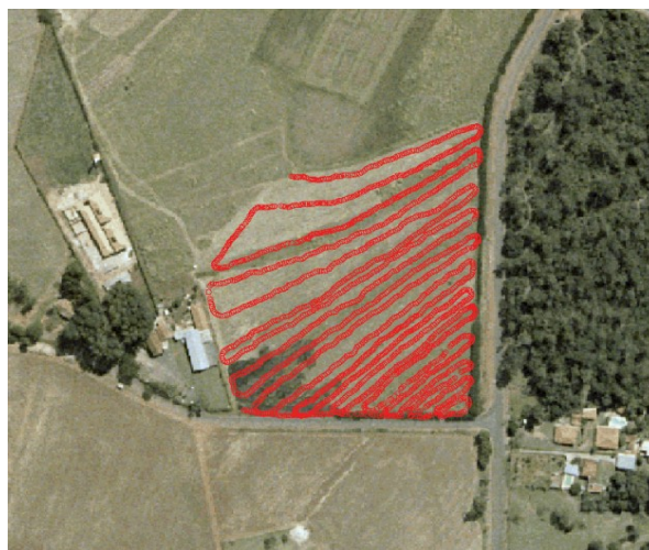
FIGURA 2: Fotografia aérea da área e o caminho executado pelo sistema Veris no levantamento da CE (em vermelho).
