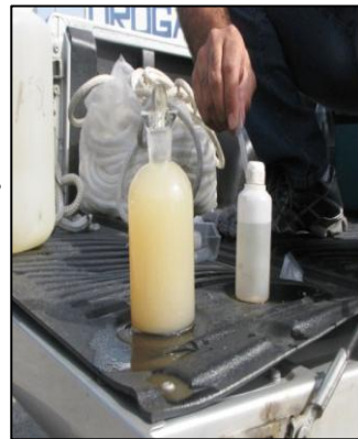
F) & G) Testing for Dissolved Oxygen.
