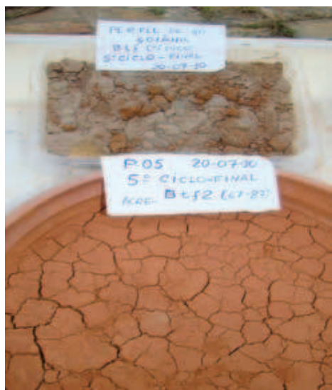
Figura 5. Aspecto da amostra de referência (bandeja retangular superior) e da amostra do perfil AC-P05 (Btf2, 67-87 cm) (bandeja circular inferior) no final do quinto e último ciclo de umedecimento e secagem. Nota-se material plíntico (agregados com cor vermelha e estáveis > 2 mm) na amostra de referência e nenhum indício de plintita na amostra Btf2 (material esboroado e fendilhado com consistência macia).
