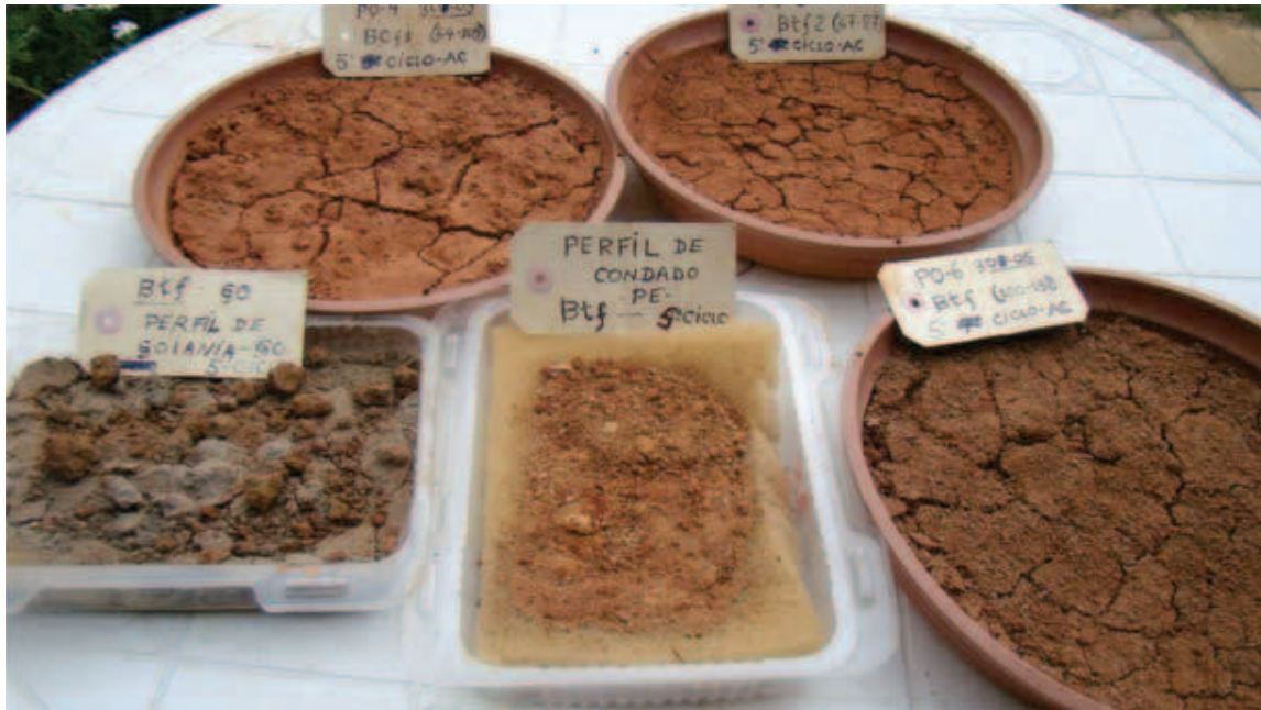
Figura 3. Aspecto geral das amostras no final do quinto e último ciclo de umedecimento e secagem. Nota-se material plíntico (agregados avermelhados estáveis > 2 mm) nas duas badejas do canto esquerdo inferior que correspondem às amostras de referência.
