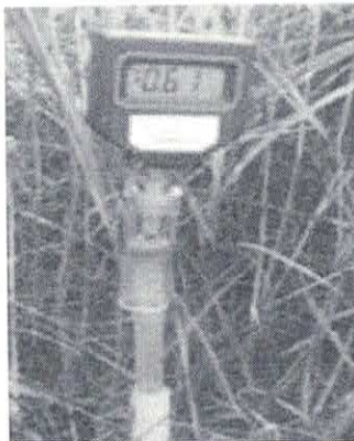
Figura 2 – Tensímetro digital registrando potencial matricial de -61 kPa.
