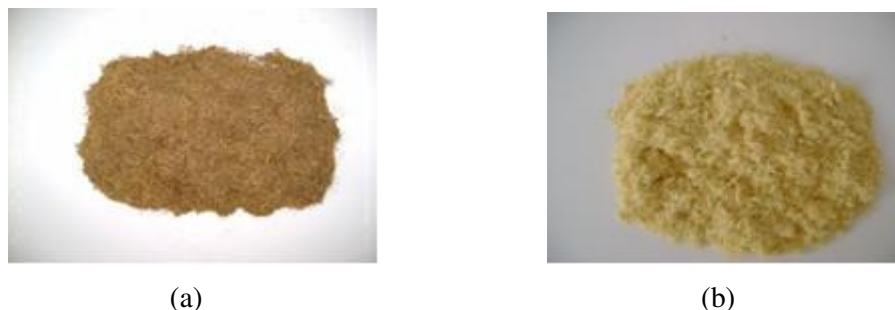
Figura 1: Fibra de dendê natural (a), Fibras de dendê branqueado (b).
