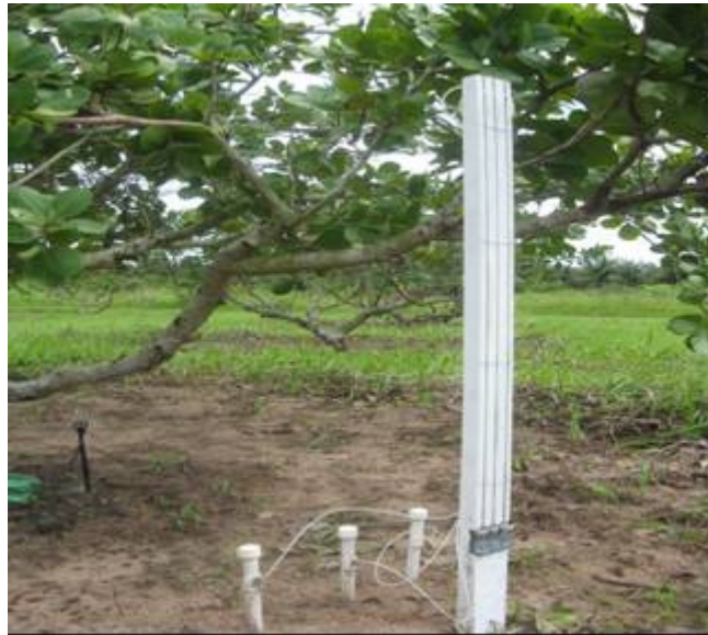
Figura 3 – Bateria de tensiômetros.
