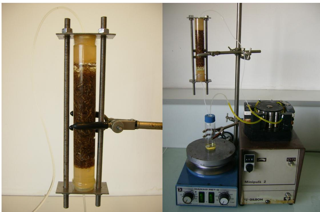
FIGURA 8 – REATOR DE LEITO FIXO UTILIZADO PARA REAÇÕES DE TRANSESTERIFICAÇÃO, CONTENDO O SÓLIDO FERMENTADO PRODUZIDO PELA *Burkholderia cepacia* LTEB11 E OS SUBSTRATOS ÓLEO DE SOJA E ETANOL. O REATOR POSSUI 1,7 cm DE DIÂMETRO INTERNO E 10 cm DE ALTURA.
