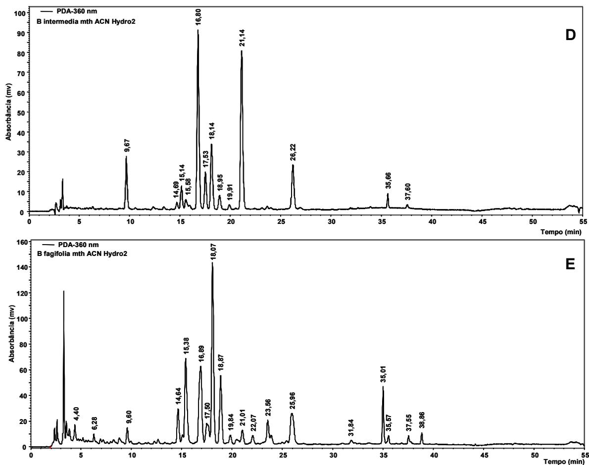
**Figura 3.8.** Separação cromatográfica por HPLC-PAD de flavonóides presentes no infuso das folhas de: **A)** *B. coccolobifolia*; **B)** *B. crassa*; **C)** *B. basiloba*; **D)** *B. intermedia*; **E)** *B. fagifolia*. Coluna Phenomenex® Synergi Hydro (250 x 4.0 mm i.d.; 4  $\mu$ m), HPLC (Jasco®). Volume injetado: 20,0  $\mu$ L, fluxo: 1,0 mL min<sup>-1</sup>,  $\lambda$  = 360 nm. (Para condições de eluição veja Tabela 3.2, sistema 2).
