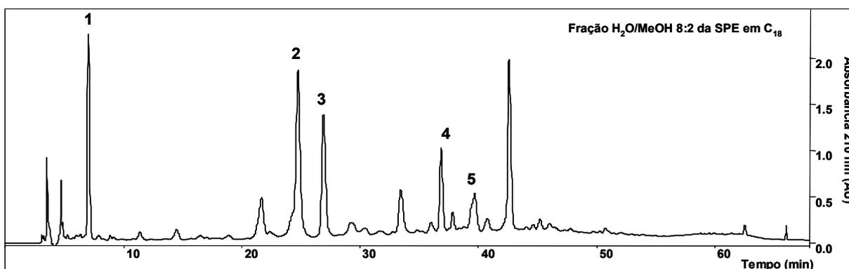
**Figura 3.3.** Cromatograma de separação por HPLC-PAD do eluato MeOH/H<sub>2</sub>O 2:8 v/v obtido após *clean-up* em SPE de 10 mg do extrato MeOH das folhas de *B. crassa*. Identificação: **1** ácido gálico; **2** galato de metila; **3** catequina; **4** *epicatequina*; **5** galato de *epigallocatequina*. Coluna Phenomenex® Luna (2) RP18 (250 x 4.6 mm i.d.; 5 µm), HPLC (Varian®), fluxo 1,0 mL min<sup>-1</sup>, λ = 210 nm. (Para condições de eluição veja Tabela 3.1, Sistema 1).
