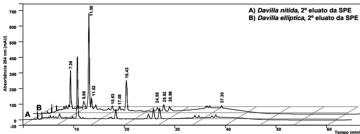
**Figura 2.10.** Cromatogramas de separação por HPLC monitorados em 254 nm. Análise do segundo eluato obtido após *clean-up* de 10 mg dos extratos MeOH das folhas de *D. nitida* (A) e *D. elliptica* (B). Coluna Phenomenex® Luna (2) RP18 (250 x 4.6 mm i.d.; 5 µm), HPLC (Varian®), fluxo 1,0 mL min<sup>-1</sup>. (Para condições de eluição veja Tabela 2.4).
