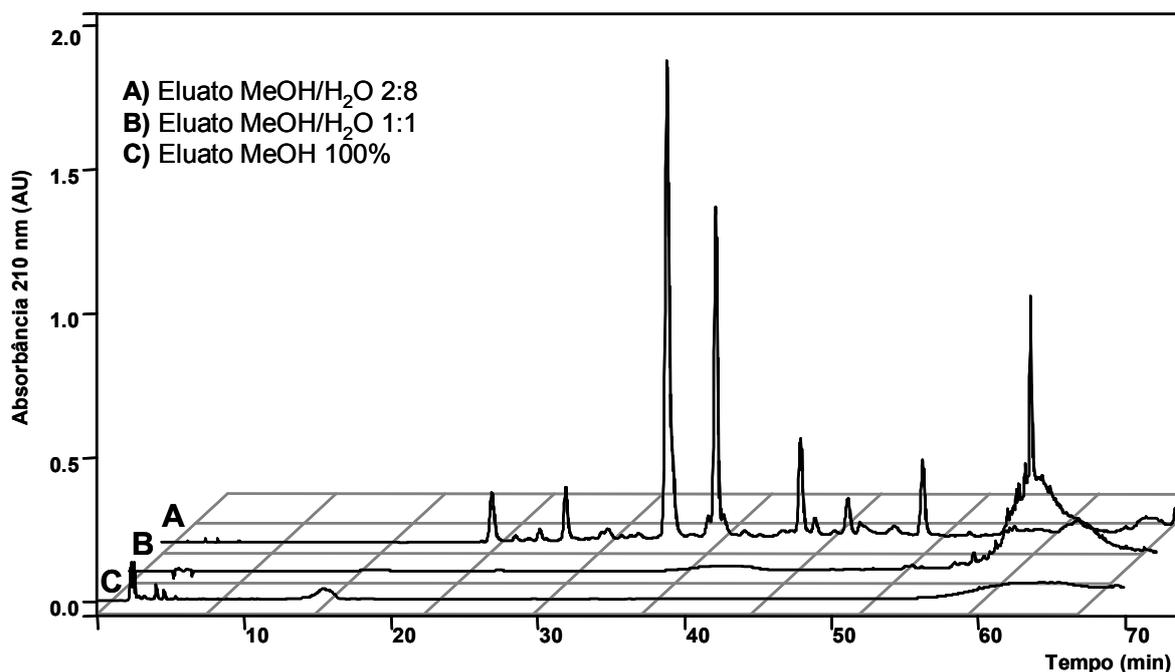
**Figura 1.5.** **A)** cromatograma do primeiro eluato da SPE (MeOH/H<sub>2</sub>O 2:8 v/v). **B)** cromatograma do segundo eluato da SPE (MeOH/H<sub>2</sub>O 1:1 v/v). **C)** cromatograma do terceiro eluato da SPE (MeOH 100%). Coluna Phenomenex<sup>®</sup> Luna (2) RP18 (250 x 4.6 mm i.d.; 5  $\mu$ m), HPLC-PAD (Varian<sup>®</sup>), fluxo 1,0 mL min<sup>-1</sup>,  $\lambda = 210$  nm. (Para condições de eluição veja Tabela 1.1 e para processo de SPE em RP18 veja Esquema 1.2A).
