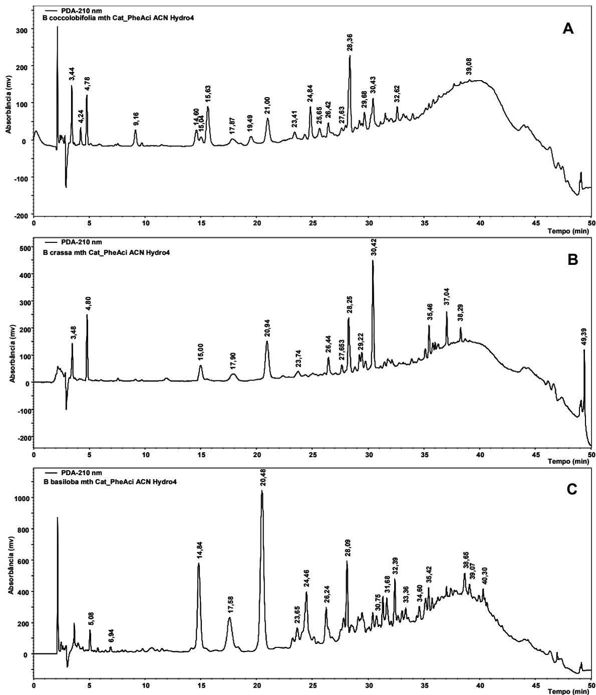
**Figura 3.7.** Separação cromatográfica por HPLC-PAD do infuso das folhas de: **A)** *B. coccolobifolia*; **B)** *B. crassa*; **C)** *B. basiloba*; **D)** *B. intermedia*; **E)** *B. fagifolia*. Coluna Phenomenex® Synergi Hydro (250 x 4.0 mm i.d.; 4 µm), HPLC (Jasco®). Volume injetado: 20,0 µL, fluxo: 1,0 mL min<sup>-1</sup>, λ = 210 nm. (Para condições de eluição veja Tabela 3.2, sistema 1).
