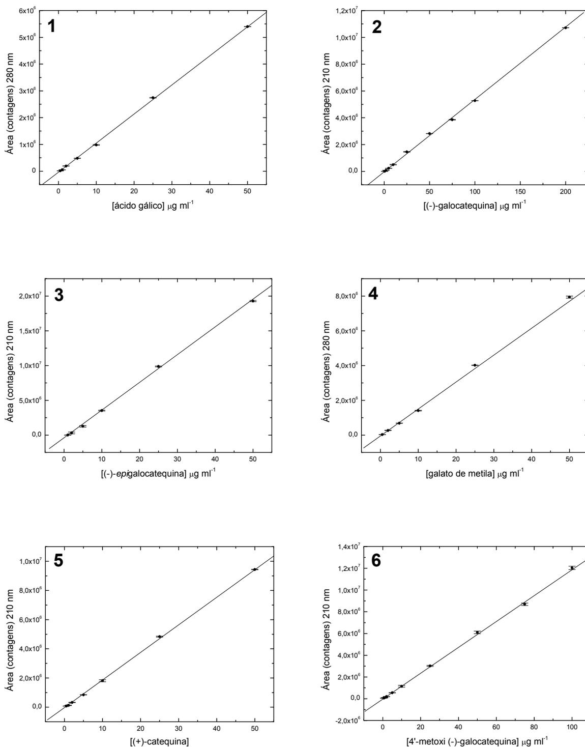
**Figura 1.18.** Curvas analíticas obtidas pelo método de calibração externa a partir de injeções em triplicata de soluções padrões de: **1** ácido gálico, **2** (-)-galocatequina, **3** (-)-epigalocatequina, **4** galato de metila, **5** (+)-catequina, **6** 4'-O-metil-galocatequina, **7** (-)-epicatequina, **8** galato de (-)-galocatequina, **9** galato de etila, **10** galato de (-)-epicatequina.
