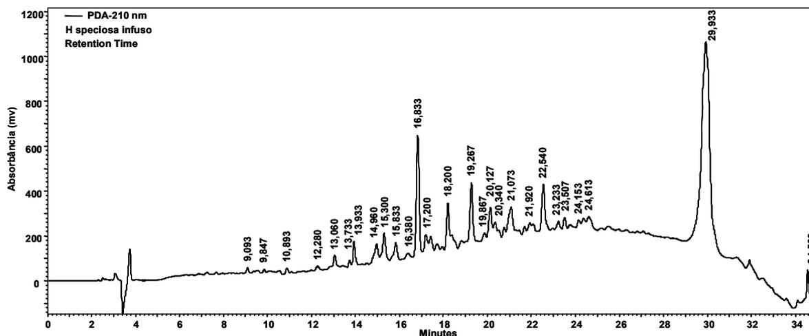
**Figura 1.21.** Separação cromatográfica dos metabólitos secundários encontrados no infuso das cascas de *H. speciosa*. Coluna Phenomenex® Synergi Hydro (250 x 4.0 mm i.d.; 4 µm), HPLC-PAD (Jasco®). Volume injetado: 20,0 µL, fluxo: 1,0 mL min<sup>-1</sup>, λ = 210 nm. (Para condições de eluição veja Tabela 1.3).
