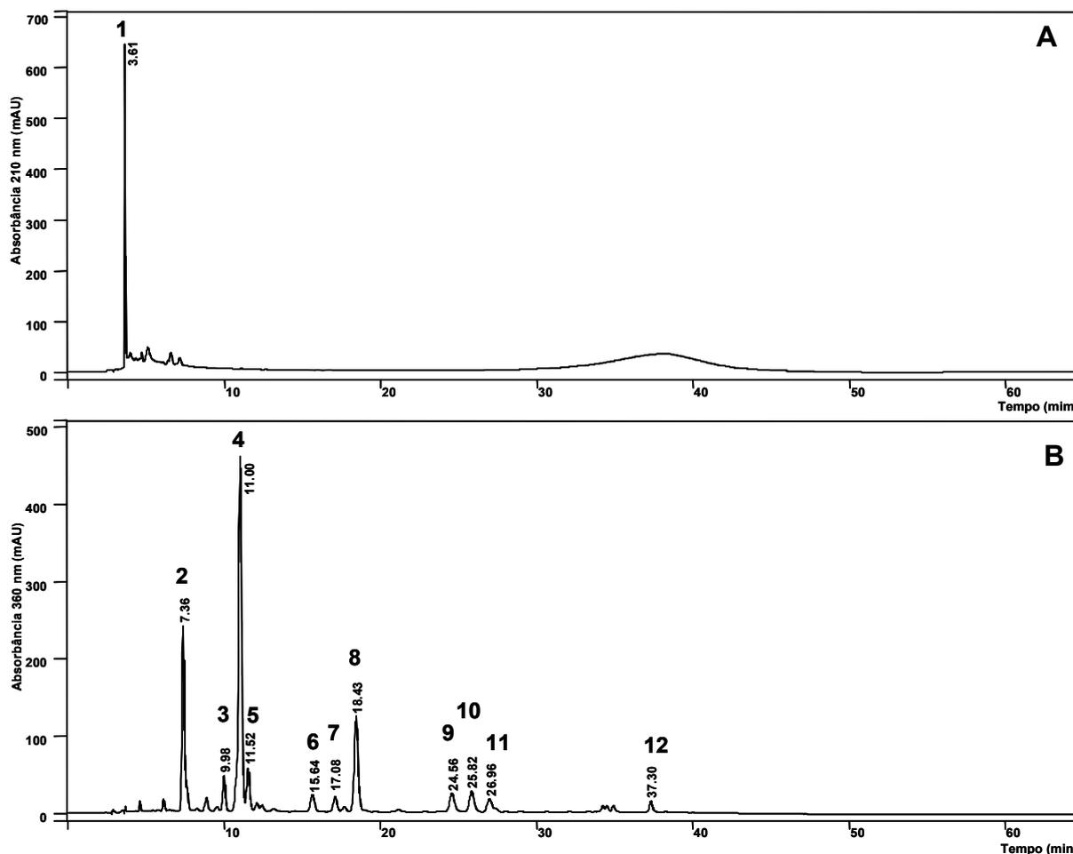
**Figura 2.7.** Identificação dos constituintes químicos de *D. elliptica* eluídos durante as análises cromatográficas do primeiro eluato da SPE (A) monitorado em 210 nm e do segundo eluato da SPE (B) monitorado em 360 nm. Coluna Phenomenex® Luna (2) RP18 (250 x 4.6 mm i.d.; 5  $\mu$ m), HPLC (Varian®), fluxo 1,0 mL min<sup>-1</sup>. (Para condições de eluição veja Tabela 2.4).
