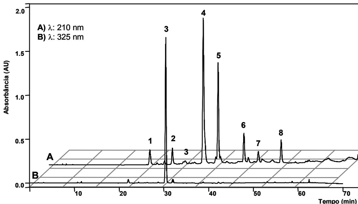
**Figura 1.6.** Perfil cromatográfico do eluato MeOH/H<sub>2</sub>O 2:8 v/v do infuso das cascas de *H. speciosa* submetido ao processo de SPE. **A)** Cromatograma processado em 210 nm e **B)** cromatograma processado em 325 nm. Coluna Phenomenex<sup>®</sup> Luna (2) RP18 (250 x 4.6 mm i.d.; 5 µm), HPLC-PAD (Varian<sup>®</sup>), fluxo 1,0 mL min<sup>-1</sup>. (Para condições de eluição veja Tabela 1.1).
