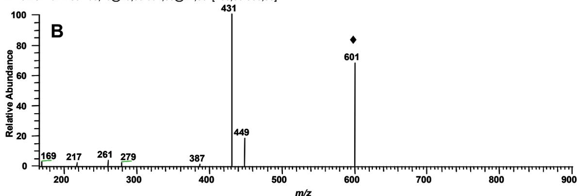
**Figura 3.17. A)** Espectro de massas de segunda-ordem do íon precursor de  $m/z$  799, obtido em modo negativo com energia de colisão de 30%. **B)** Espectro de massas de terceira-ordem ( $MS^3$ ) do íon produto de  $m/z$  601, obtido em modo negativo com energia de colisão de 30%. Para condições espectrométricas veja: Parte Experimental.
