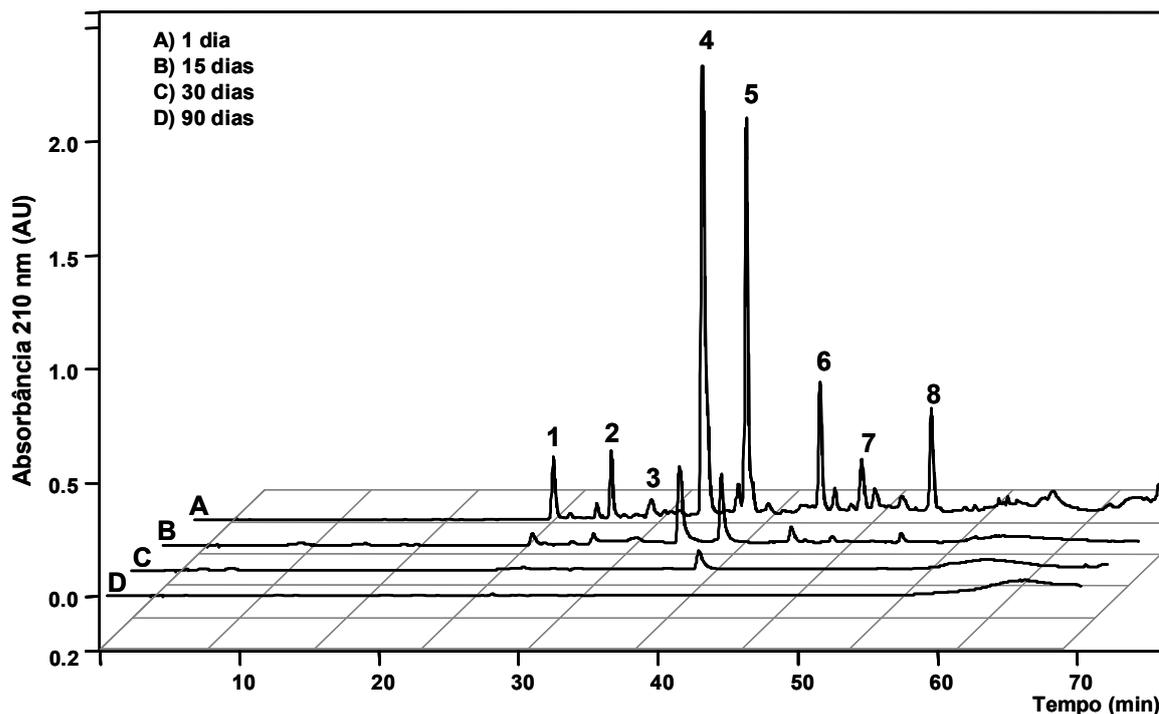
**Figura 1.8.** Avaliação da degradação do conteúdo de catequinas a partir de análises cromatográficas de uma amostra (eluato MeOH/H<sub>2</sub>O 2:8 v/v após *clean-up* em *Sep Pak RP18*) submetida à ação de luz e calor. Intervalos: **A)** 1 dia; **B)** 15 dias; **C)** 30 dias e **D)** 90 dias. Coluna Phenomenex® Luna (2) RP18 (250 x 4.6 mm i.d.; 5 µm), HPLC-PAD (Varian®), fluxo 1,0 mL min<sup>-1</sup>, λ = 210 nm. (Para condições de eluição veja Tabela 1.1).
