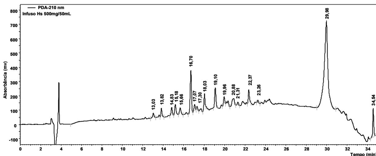
**Figura 1.22.** Separação cromatográfica empregada na etapa quantitativa dos metabólitos secundários encontrados no infuso das cascas de *H. speciosa*. Coluna Phenomenex® Synergi Hydro (250 x 4.0 mm i.d.; 4 µm), HPLC-PAD (Jasco®). Volume injetado: 20,0 µL, fluxo: 1,0 mL min<sup>-1</sup>, λ = 210 nm. (Para condições de eluição veja Tabela 1.3).
