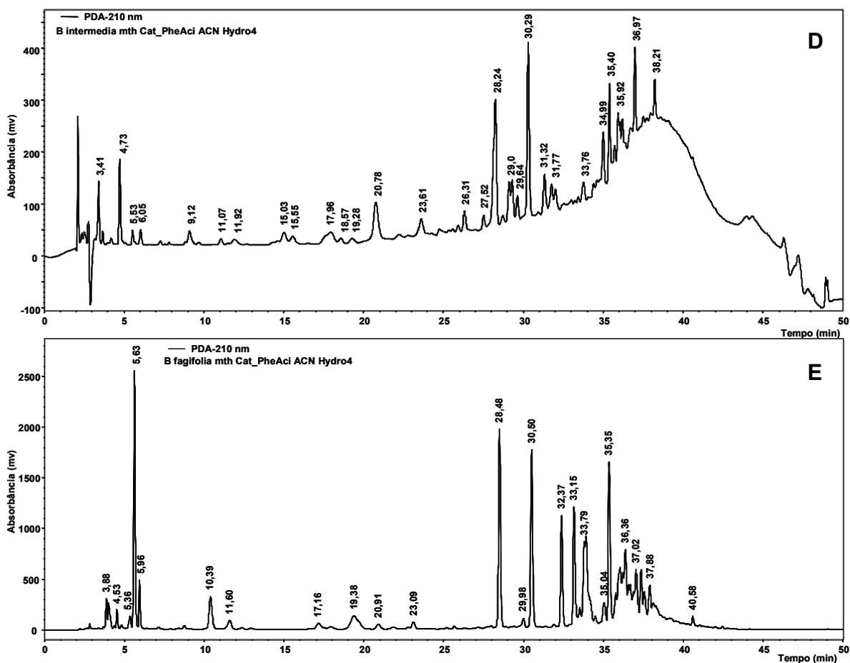
**Figura 3.7.** Separação cromatográfica por HPLC-PAD do infuso das folhas de: **A)** *B. coccolobifolia*; **B)** *B. crassa*; **C)** *B. basiloba*; **D)** *B. intermedia*; **E)** *B. fagifolia*. Coluna Phenomenex® Synergi Hydro (250 x 4.0 mm i.d.; 4 µm), HPLC (Jasco®). Volume injetado: 20,0 µL, fluxo: 1,0 mL min<sup>-1</sup>, λ = 210 nm. (Para condições de eluição veja Tabela 3.2, sistema 1).
