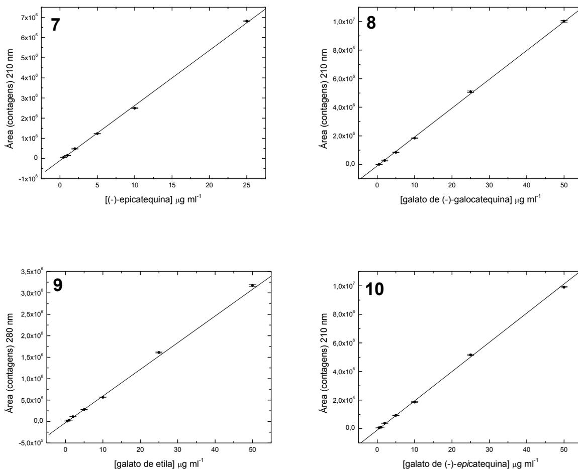
**Figura 1.18.** Curvas analíticas obtidas pelo método de calibração externa a partir de injeções em triplicata de soluções padrões de: **1** ácido gálico, **2** (-)-galocatequina, **3** (-)-epigalocatequina, **4** galato de metila, **5** (+)-catequina, **6** 4'-O-metil-galocatequina, **7** (-)-epicatequina, **8** galato de (-)-galocatequina, **9** galato de etila, **10** galato de (-)-epicatequina.
