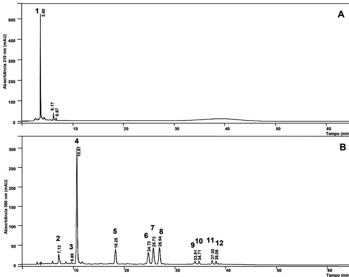
**Figura 2.8.** Identificação dos constituintes químicos de *D. nitida* eluídos durante as análises cromatográficas do primeiro eluato da SPE (A) monitorado em 210 nm e do segundo eluato da SPE (B) monitorado em 360 nm. Coluna Phenomenex® Luna (2) RP18 (250 x 4.6 mm i.d.; 5 µm), HPLC (Varian®), fluxo 1,0 mL min<sup>-1</sup>. (Para condições de eluição veja Tabela 2.4).
