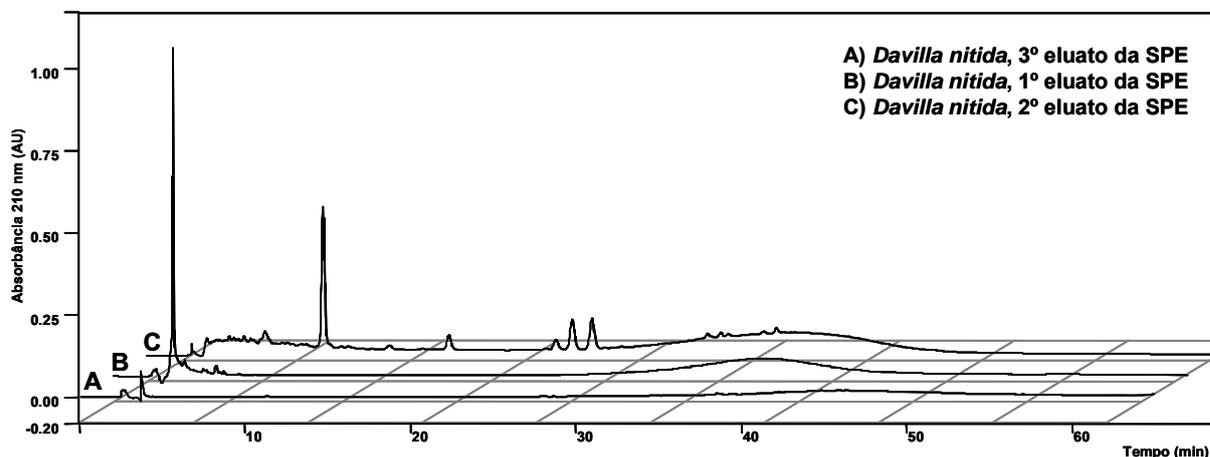
**Figura 2.5.** Efeito da presença do ácido trifluoroacético (TFA) na concentração de 0,05 % v/v durante a separação dos constituintes químicos presentes nos três eluatos da SPE de *D. nitida*. Coluna Phenomenex® Luna (2) RP18 (250 x 4.6 mm i.d.; 5 µm), HPLC (Varian®), fluxo 1,0 mL min<sup>-1</sup>, λ = 210 nm. (Para condições de eluição veja Tabela 2.4).
