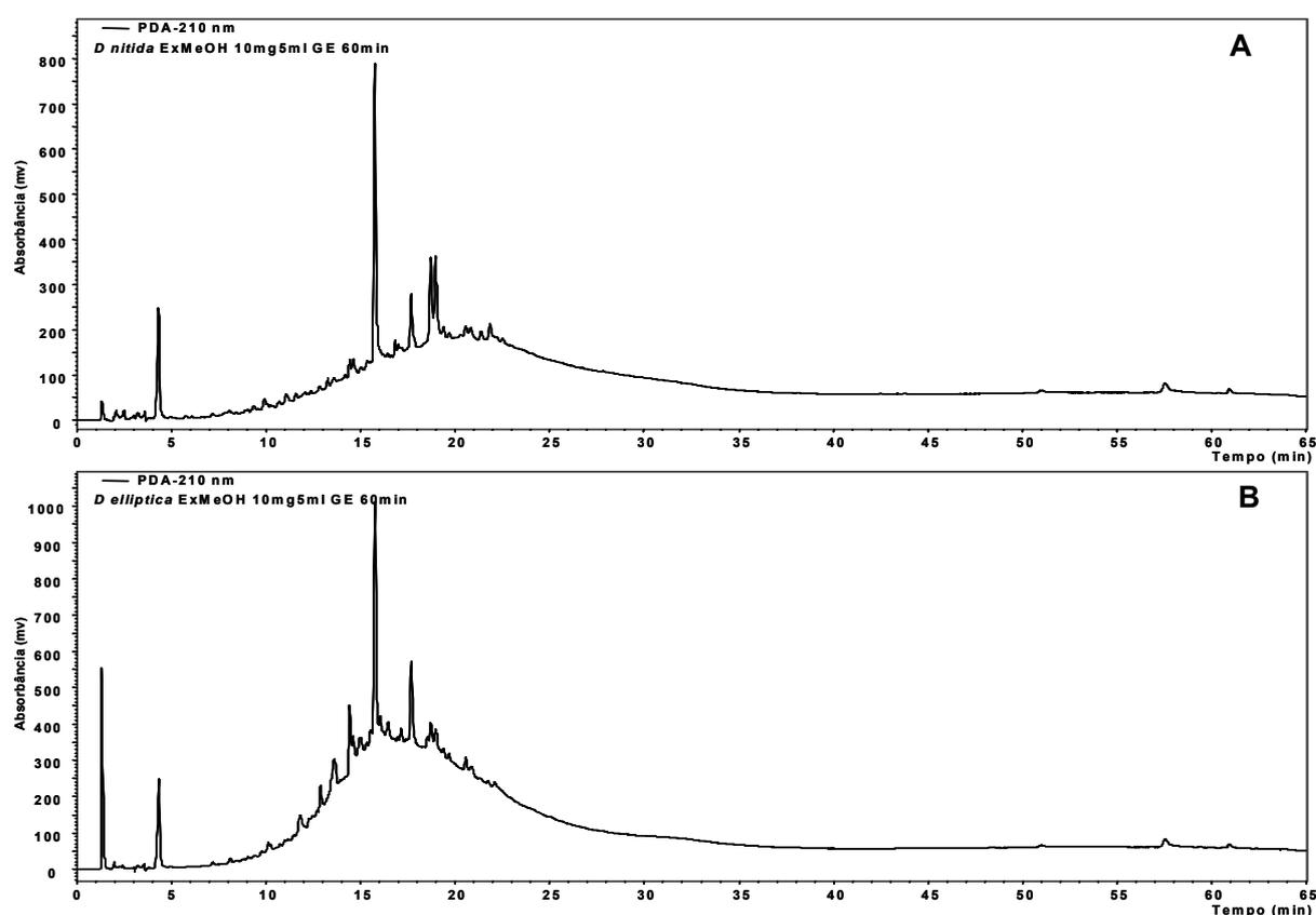
**Figura 2.2.** Perfis cromatográficos dos extratos MeOH de *D. nitida* (A) e *D. elliptica* (B). Coluna Phenomenex® Luna (2) RP18 (250 x 4.6 mm i.d.; 5 µm), HPLC-PAD (Jasco®), fluxo 1,0 mL min<sup>-1</sup>, λ = 210 nm. (Para condições de eluição veja Tabela 2.2).
