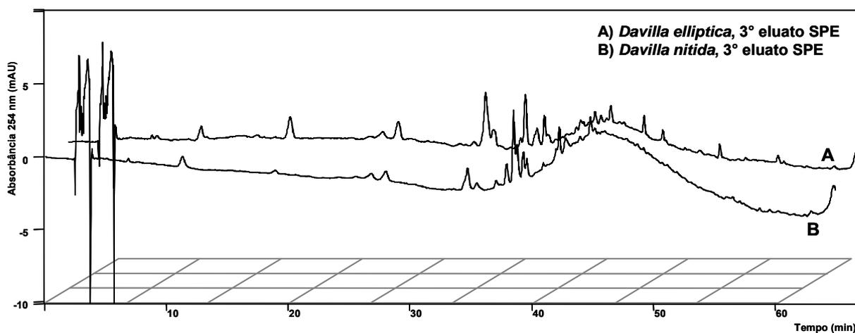
**Figura 2.11.** Cromatogramas de separação por HPLC monitorados em 254 nm. Análise do terceiro eluato obtido após *clean-up* de 10 mg dos extratos MeOH das folhas de *D. elliptica* (A) e *D. nitida* (B). Coluna Phenomenex® Luna (2) RP18 (250 x 4.6 mm i.d.; 5 µm), HPLC (Varian®), fluxo 1,0 mL min<sup>-1</sup>. (Para condições de eluição veja Tabela 2.4).
