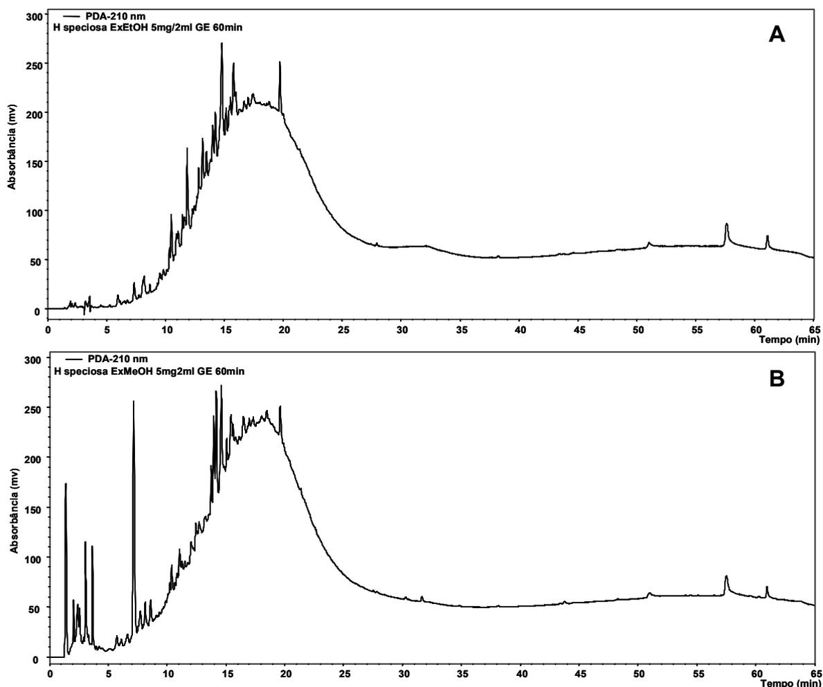
**Figura 1.3.** Perfis cromatográficos do extrato EtOH (A) e do extrato MeOH (B) das cascas de *H. speciosa* obtidos por HPLC-PAD. Sistema de eluição gradiente: 5-100% ACN em 60 min, coluna Phenomenex® Luna (2) RP18 (250 x 4.6 mm i.d.; 5  $\mu$ m), HPLC (Jasco®), fluxo 1,0 mL min<sup>-1</sup>,  $\lambda$  = 210 nm.
