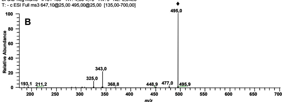
**Figura 3.16.** A) Espectro de massas de segunda-ordem do íon precursor de  $m/z$  647, obtido em modo negativo com energia de colisão de 30%. B) Espectro de massas de terceira-ordem ( $MS^3$ ) do íon produto de  $m/z$  495, obtido em modo negativo com energia de colisão de 30%. Para condições espectrométricas veja: Parte Experimental.
