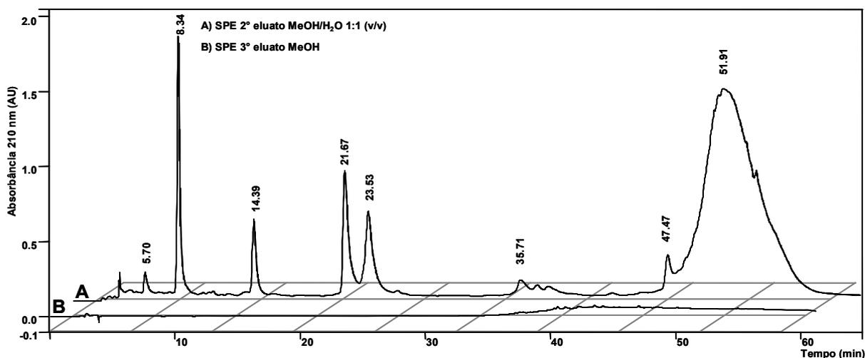
**Figura 2.4.** Separação cromatográfica por HPLC-PAD do segundo eluato (MeOH/H<sub>2</sub>O 1:1, v/v) (A) e do terceiro eluato (MeOH 100%) (B) do extrato MeOH de *D. nitida* submetido ao processo de SPE em cartucho *Sep Pak* de RP18. Coluna Phenomenex<sup>®</sup> Luna (2) RP18 (250 x 4.6 mm i.d.; 5  $\mu$ m), HPLC (Varian<sup>®</sup>), fluxo 1,0 mL min<sup>-1</sup>,  $\lambda = 210$  nm. (Para condições de eluição veja Tabela 2.3, Sistema 2).
