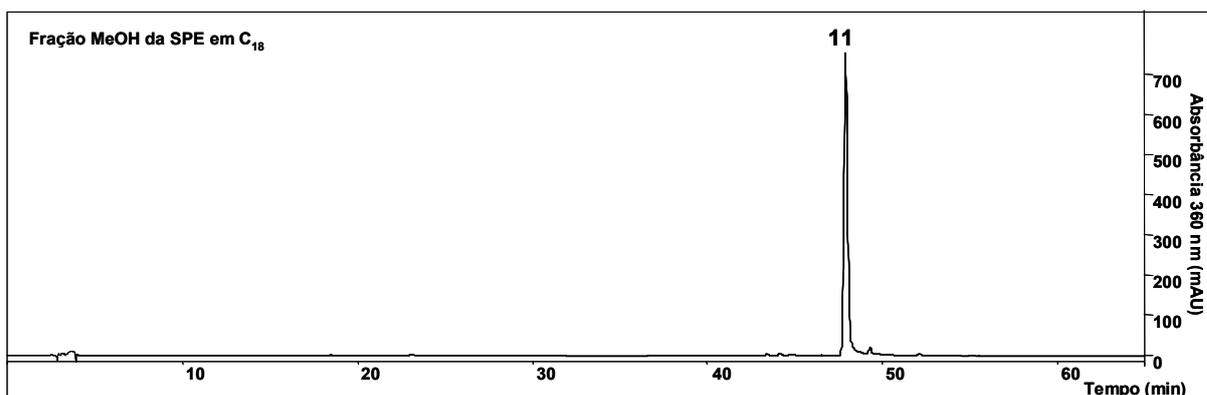
**Figura 3.5.** Cromatograma de separação por HPLC-PAD do eluato MeOH 100% obtido após *clean-up* em SPE de 10 mg do extrato MeOH das folhas de *B. crassa*. Identificação: **11** amentoflavona. Coluna Phenomenex<sup>®</sup> Luna (2) RP18 (250 x 4.6 mm i.d.; 5  $\mu$ m), HPLC (Varian<sup>®</sup>), fluxo 1,0 mL min<sup>-1</sup>,  $\lambda$  = 360 nm. (Para condições de eluição veja Tabela 3.1, Sistema 2).
