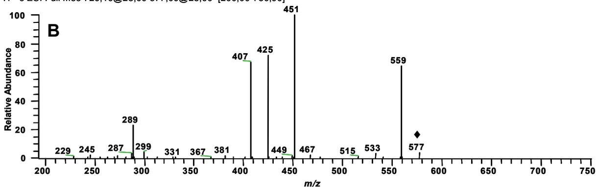
**Figura 3.11.** A) Espectro de massas de segunda-ordem do íon precursor de  $m/z$  729, obtido em modo negativo com energia de colisão de 30%. B) Espectro de massas de terceira-ordem ( $MS^3$ ) do íon produto de  $m/z$  577, obtido em modo negativo com energia de colisão de 30%. Para condições espectrométricas veja: Parte Experimental.
