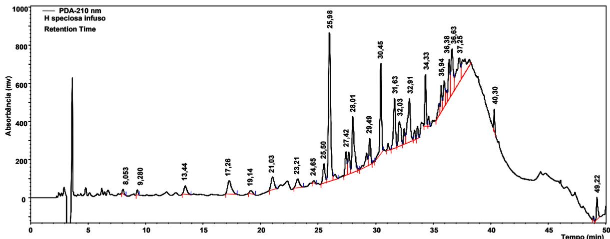
**Figura 1.20.** Separação cromatográfica dos metabólitos secundários encontrados no infuso das cascas de *H. speciosa*. Coluna Phenomenex® Synergi Hydro (250 x 4.0 mm i.d.; 4  $\mu$ m), HPLC-PAD (Jasco®). Volume injetado: 20,0  $\mu$ L, fluxo: 1,0 mL min<sup>-1</sup>,  $\lambda$  = 210 nm. (Para condições de eluição veja Tabela 1.2).
