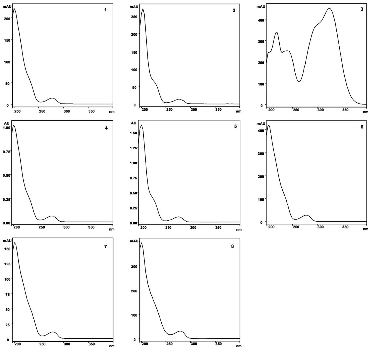
**Figura 1.7.** Espectros na região do UV para os principais picos eluídos no cromatograma da Figura 1.6. Espectros 2, 3 e 5 foram atribuídos à catequina, ácido clorogênico e à *epicatequina*, respectivamente.
