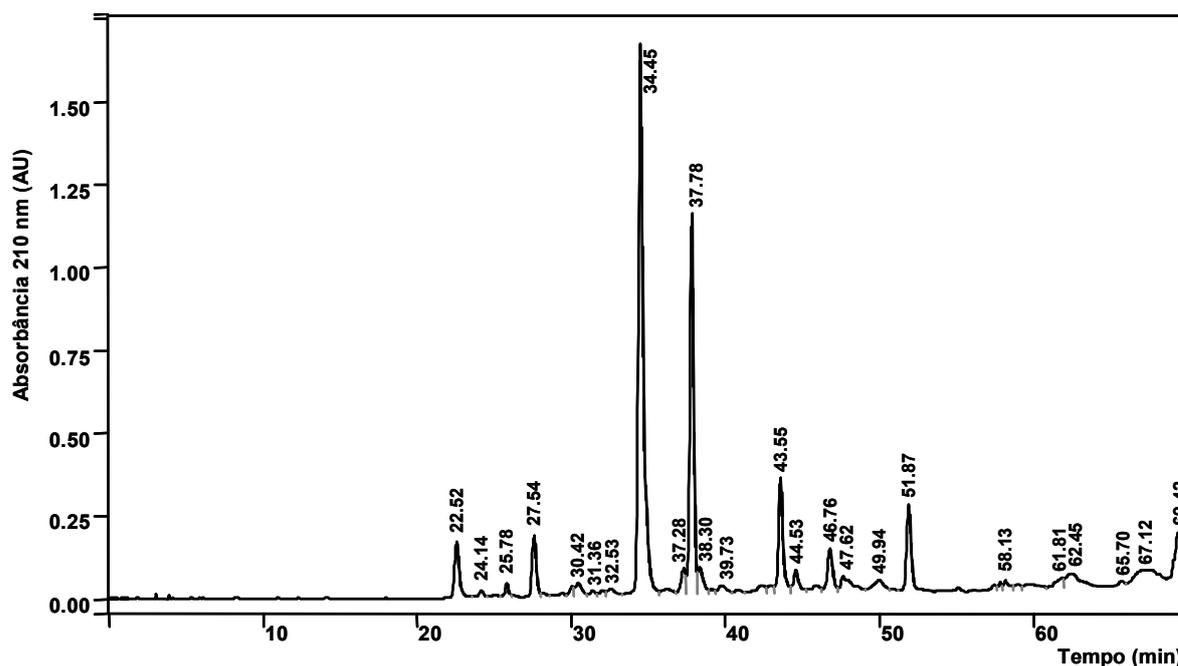
**Figura 1.4.** Perfil cromatográfico da fração MeOH/H<sub>2</sub>O 2:8 v/v proveniente do infuso das cascas de *H. speciosa*, submetida ao *clean-up* em LLE e SPE em *Sep Pak* RP18. Coluna Phenomenex<sup>®</sup> Luna (2) RP18 (250 x 4.6 mm i.d.; 5  $\mu\text{m}$ ), HPLC-PAD (Varian<sup>®</sup>), fluxo 1,0 mL min<sup>-1</sup>,  $\lambda$  = 210 nm. (Para condições de eluição veja Tabela 1.1).
