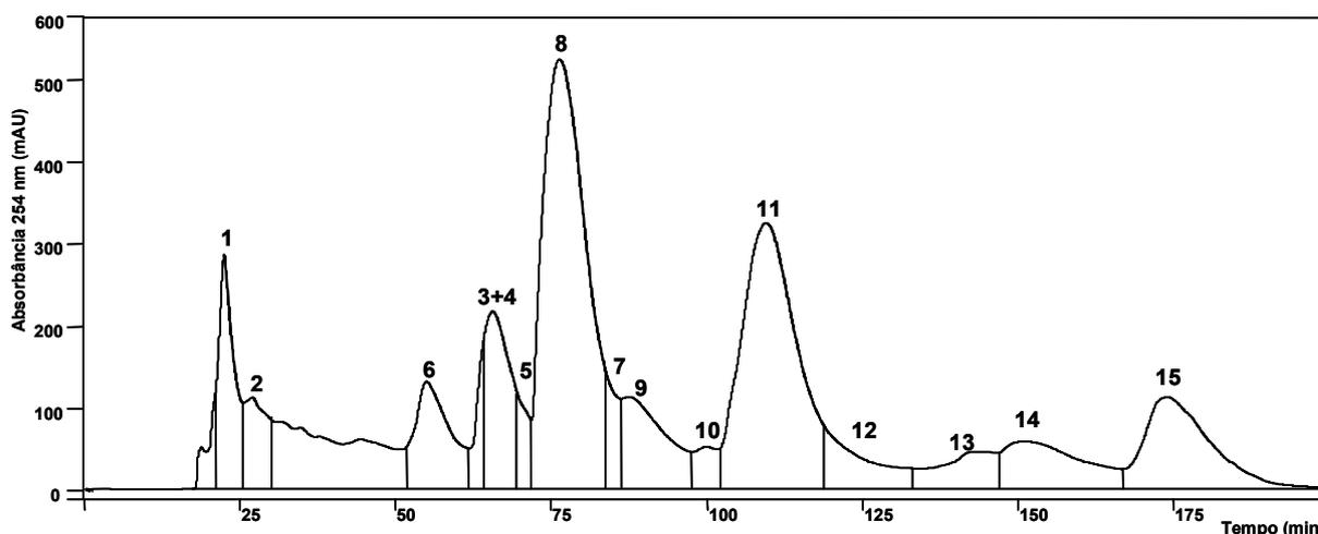
**Figura 2.13.** Cromatograma de separação por HPLC-PAD (modo preparativo) da amostra obtida após etapas de *clean-up* e enriquecimento empregando os processos de LLE e SPE no infuso das folhas de *D. elliptica*. Coluna Varian® Dynamax RP18 (250 x 41,4 mm i.d.; 8 µm), HPLC (Varian®), fluxo 15,0 mL min<sup>-1</sup>, monitorado em 254 nm, Volume injetado: 1 mL.
