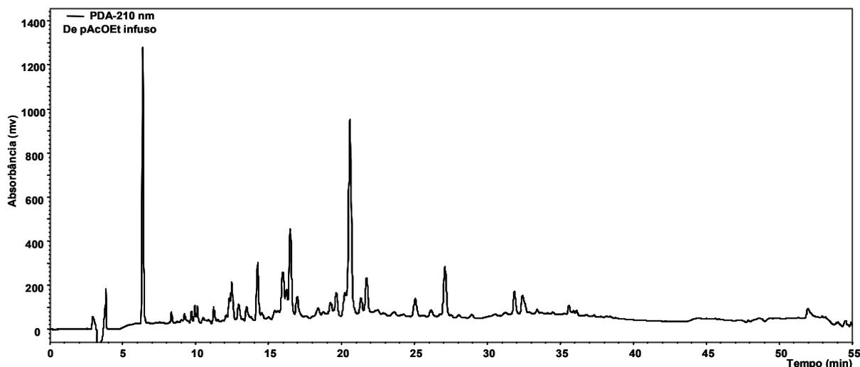
**Figura 2.12.** Separação cromatográfica por HPLC-PAD da porção acetato de etila obtida a partir da LLE do infuso das folhas de *D. elliptica* e posterior *clean-up* em *Sep Pak RP18*. Coluna Phenomenex® Luna (2) RP18 (250 x 4.6 mm i.d.; 5 µm), HPLC (Jasco®), fluxo 1,0 mL min<sup>-1</sup>. (Para condições de eluição veja Tabela 2.5).
