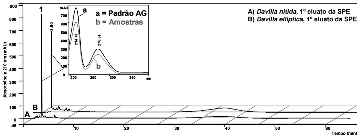
**Figura 2.9.** Cromatogramas de separação por HPLC monitorados em 210 nm. Análise do primeiro eluato obtido após *clean-up* de 10 mg dos extratos MeOH das folhas de *D. nitida* (A) e *D. elliptica* (B). Padrão AG = padrão de ácido gálico (a), substâncias identificadas (b). Coluna Phenomenex® Luna (2) RP18 (250 x 4.6 mm i.d.; 5 µm), HPLC (Varian®), fluxo 1,0 mL min<sup>-1</sup>. (Para condições de eluição veja Tabela 2.4).
