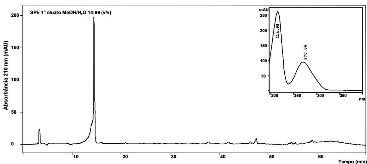
**Figura 2.3.** Separação cromatográfica por HPLC-PAD do primeiro eluato (MeOH/H<sub>2</sub>O 14:86, v/v) do extrato MeOH de *D. nitida* submetido ao processo de SPE em cartucho *Sep Pak* de RP18. Coluna Phenomenex® Luna (2) RP18 (250 x 4.6 mm i.d.; 5 µm), HPLC (Varian®), fluxo 1,0 mL min<sup>-1</sup>,  $\lambda = 210$  nm. (Para condições de eluição veja Tabela 2.3, Sistema 1).
