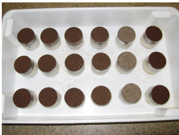
Figura 1 - Montagem experimental utilizada com os anéis volumétricos preenchidos com os solos e misturas com o chamote.
