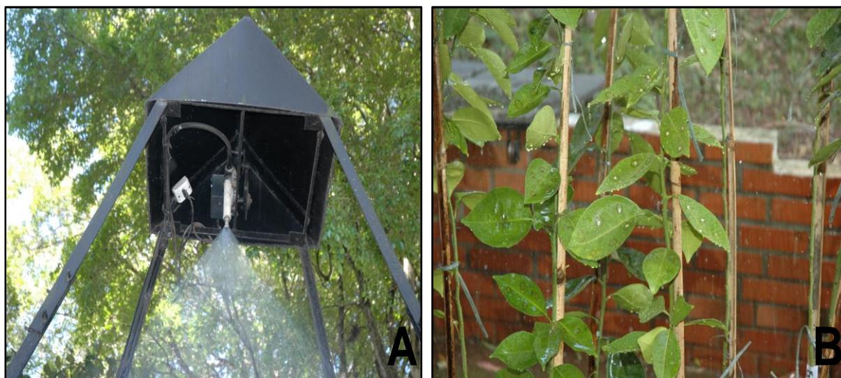
**Figura 6** - Detalhes do experimento para avaliar o efeito da chuva sobre as iscas tóxicas: A) Simulador de chuva de vazão constante; B) Mudanças de citros com as iscas tóxicas sobre as folhas, sob aspersor para simular a chuva.
