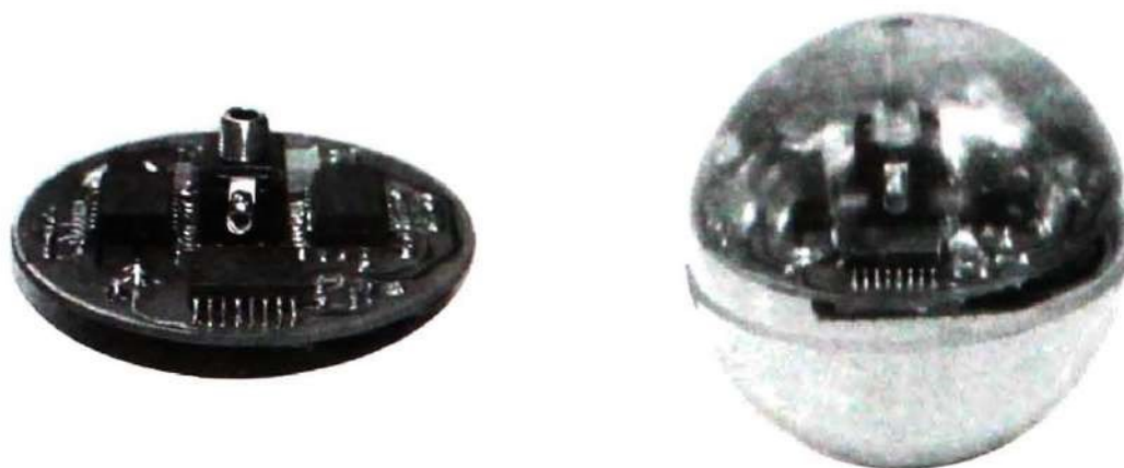
Figura 9: Fruta Eletrônica (Protótipo): dotada de acelerômetros triaxiais para medir e armazenar dados de impactos, e de um sensor de temperatura (NICOLAU, 2009).
