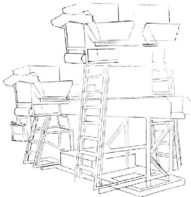
Figura 3: Modelo de plataforma móvel de auxílio à colheita, com dois níveis de altura para colheita. (Figura: Poliana Cristina Spricigo).
