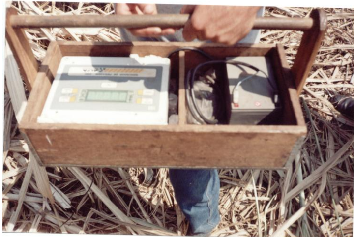
Figura 6. Visões do amarramento do feixe de cana por parcela para fins de medida de peso (a) com detalhe do aparelho de célula de carga (b).
