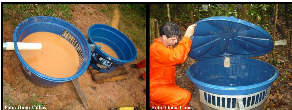
**Figura 11.** Calha coletora de água e sedimentos, caixas de água de 500 L e divisor tipo Geib utilizados neste experimento de perda de solo e água. Base de Operações Geólogo Pedro de Moura, Coari – AM.
