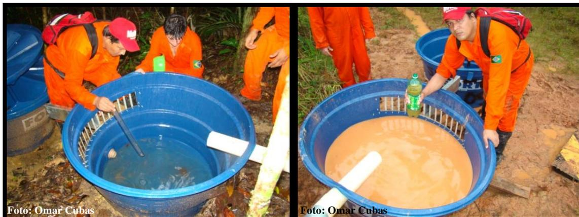
**Figura 13.** Leitura do volume de água e coleta do material erodido (água e sedimentos). Base de Operações Geólogo Pedro de Moura, Coari – AM.
