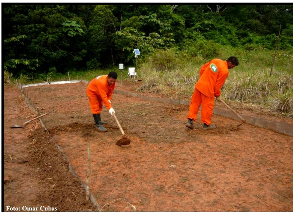
**Figura 8.** Capina manual e retirada dos três primeiros centímetros do solo para instalação das parcelas coletoras padrão de erosão na Jazida 21. Base de Operações Geólogo Pedro de Moura, Coari - AM.
