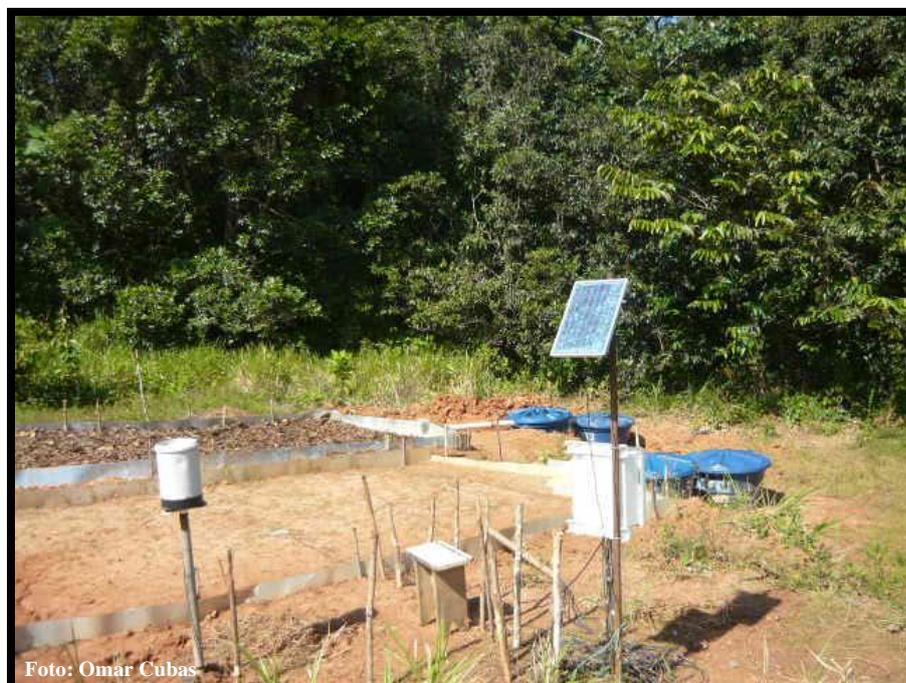
**Figura 12.** Pluviômetro e datalogger (CR23X Campbell - EUA) conectados em painel solar na jazida 21. Base de Operações Geólogo Pedro de Moura, Coari – AM.
