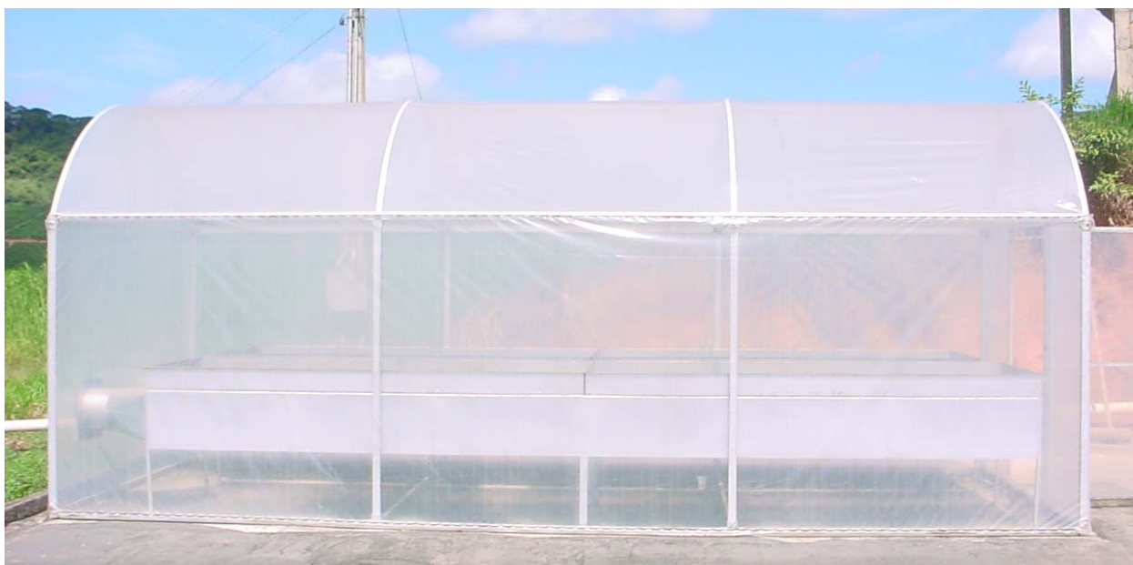
Figura 1 – Estufa utilizada para secagem dos grãos de café cereja descascado da espécie Coffea arabica L..
