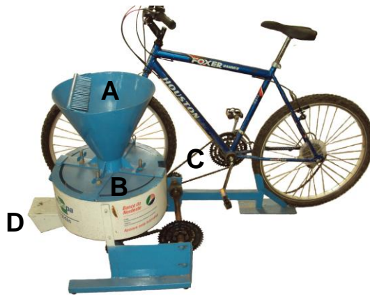
Figura 1. Componentes do descascador de frutos de R. communis : Alimentador (A); sistema de descascamento - discos (B); sistema de acionamento - pedal de bicicleta (C); e descarga do material descascado (D).
