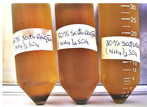
Figura 10. Amostras das três condições de saturação, 60%, 50% e 80% da esquerda para a direita, respectivamente, após a precipitação e centrifugação.
