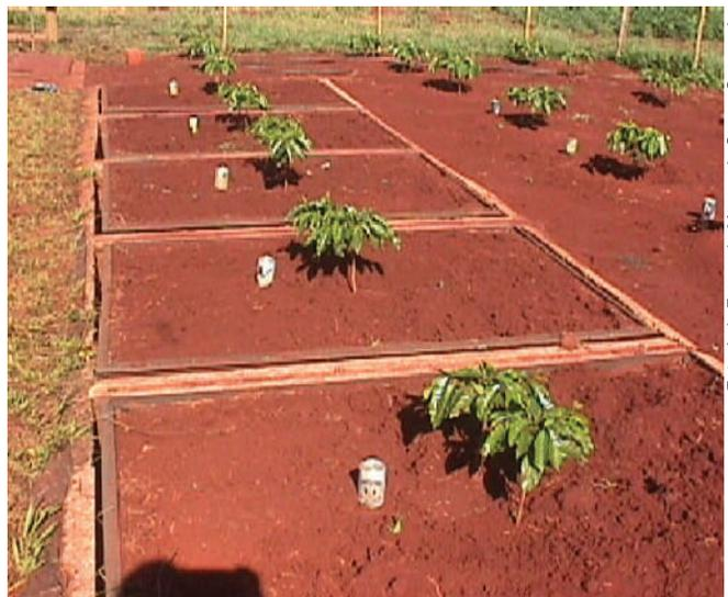
**Figura 5.** Vista superior de lisímetros de pesagem.
