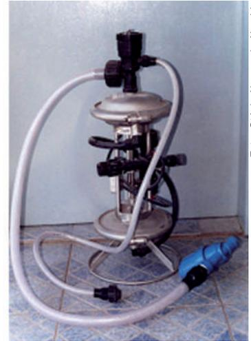
**Figura 15.** Bombas injetoras de acionamento hidráulico.
