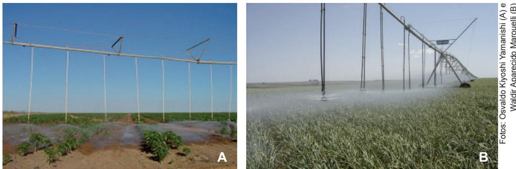
**Figura 5.** Sistema de irrigação por aspersão tipo pivô central com tubo de descida na cultura do mamão (A) e do alho (B).
