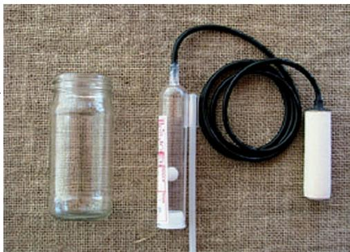
**Figura 4.** Sistema Irrigas® comercial, na sua forma básica, incluindo cápsula porosa (sensor), tubo de plástico flexível, cuba de leitura e frasco para teste de imersão.
