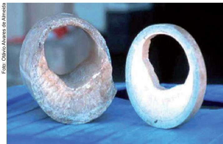
**Figura 19.** Obstrução da tubulação por decantação de carbonato.
