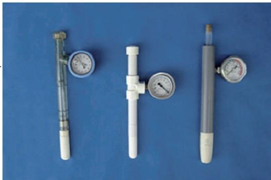
**Figura 2.** Tensiômetros com vacuômetro metálico tipo Bourdon.
