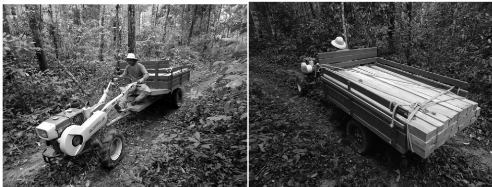
FIGURA 5: Transporte primário da madeira serrada com micro-tractor e reboque.
