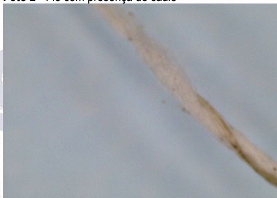
Foto 4 - Fio contaminado com caule
