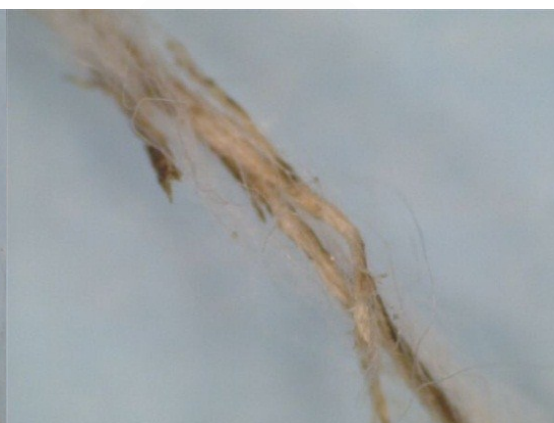
Foto 2 - Fio com presença de caule
