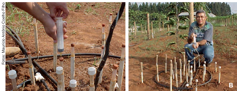
Figura 9. Procedimento de extração de solução do solo utilizando-se extratores de cápsula porosa e seringa descartável: vácuo (A) e extração da solução (B).
