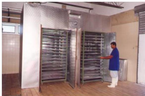
**Figura 2.** Secador de cabine com capacidade para até 500 kg (Foto: Felix E.P. Cornejo)
