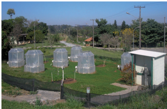
Figura 1. Cámaras con techo abierto en EMBRAPA Environment, Jaguariúna, SP, Brasil.
