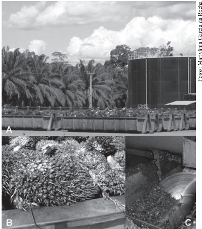
Figura 5. Palmeiras ao lado de caçambas com cachos de dendê colhidos e tanque de armazenagem de óleo (A). Detalhe de cachos de frutos (B) e fase de prensagem do processo de extração de óleo de palma (C).
