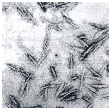
**Figura 4** - Micrografia obtida por MET das nanofibras de algodão.
