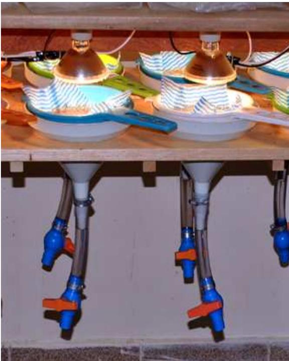
Figura 1. Extrator de enquitreídeos com aquecimento por lâmpadas incandescentes baseado em O'Connor (1962).
