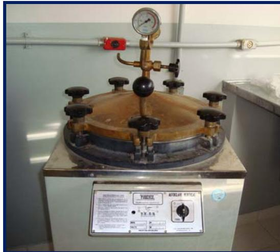
**Figura 2.** Autoclave utilizada para esterilização dos dispositivos intravaginais de progesterona.
