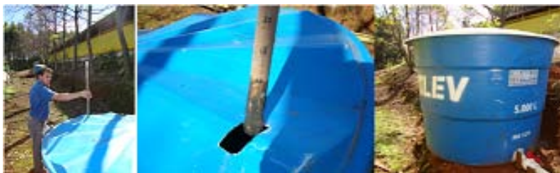
Figura 2 – Medição da altura do dejetos na caixa de fibra de vidro
