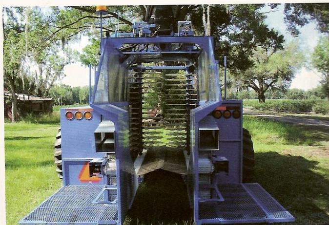
Figura 14 - Máquina para colheita mecânica de mirtilo
