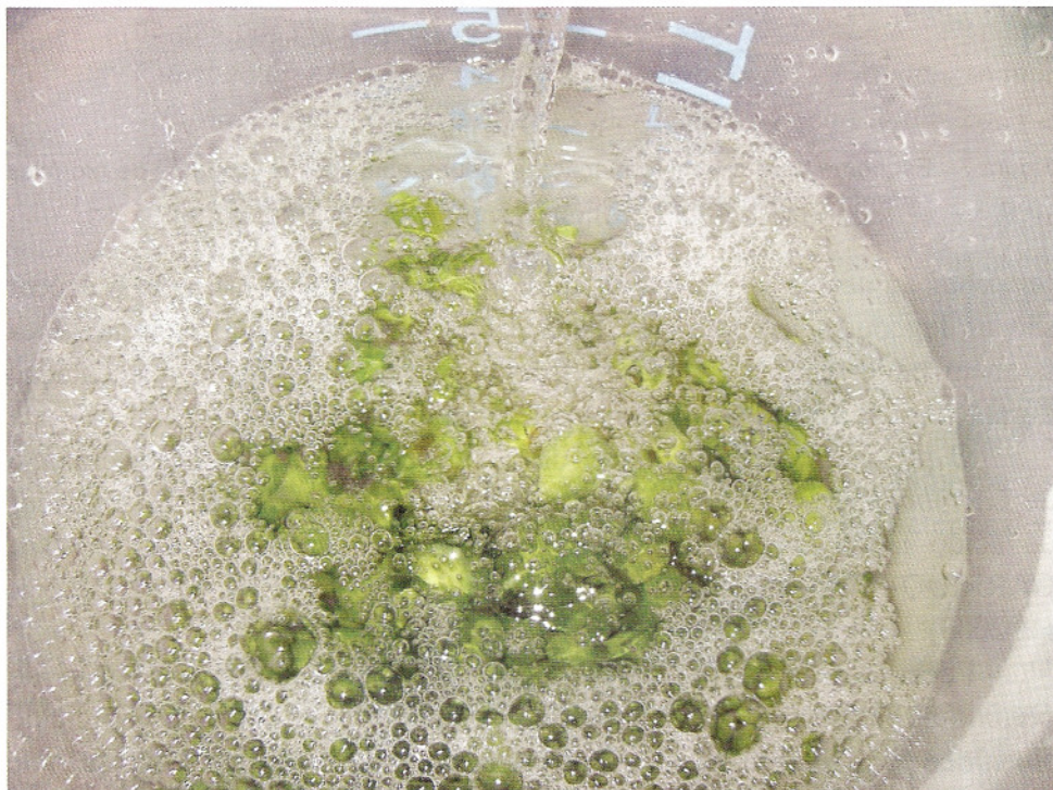
Figura 6 - Lavagem para remoção do excesso de hidróxido de sódio
