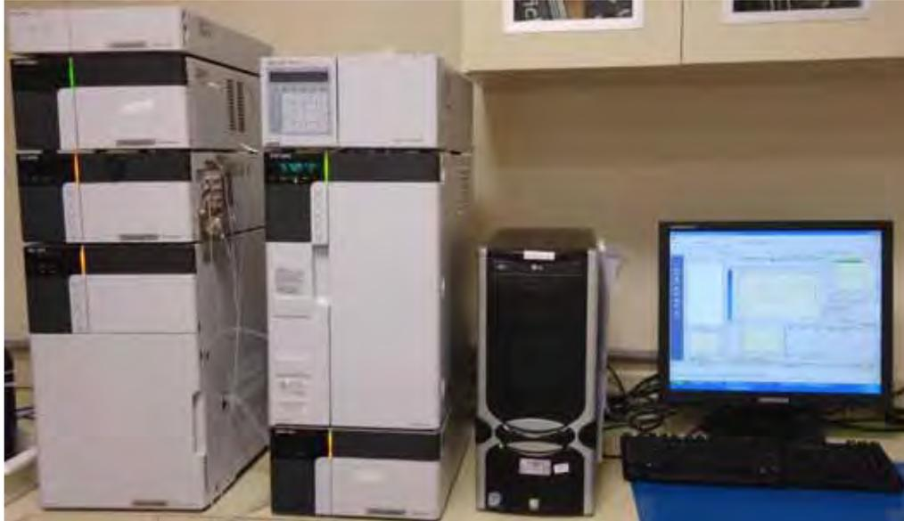
Figura 2. Imagem do equipamento do HPLC (High Performance Liquid Chromatography) utilizado para identificação e quantificação de compostos secundários de extratos vegetais obtidos de vagem e grão de soja.
