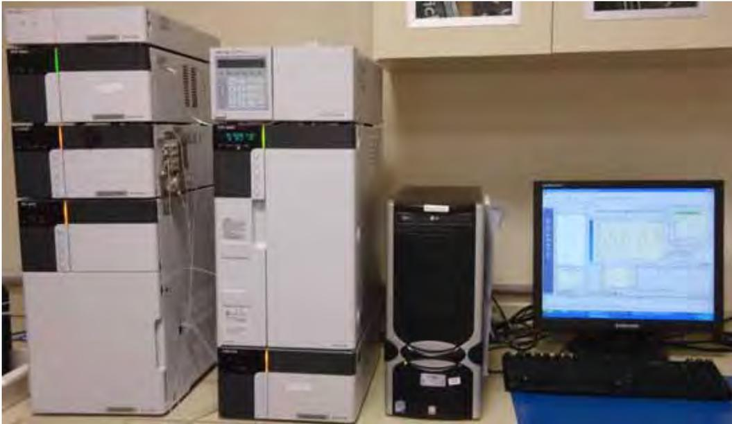
Figura 2. Imagem do equipamento do HPLC (High Performance Liquid Chromatography) utilizado para identificação e quantificação de extratos vegetais e imagem do software .
